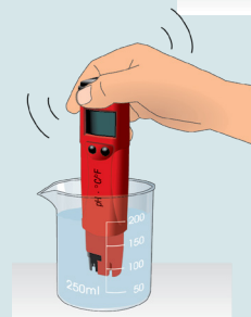
Huuhtelu ennen mittausta
